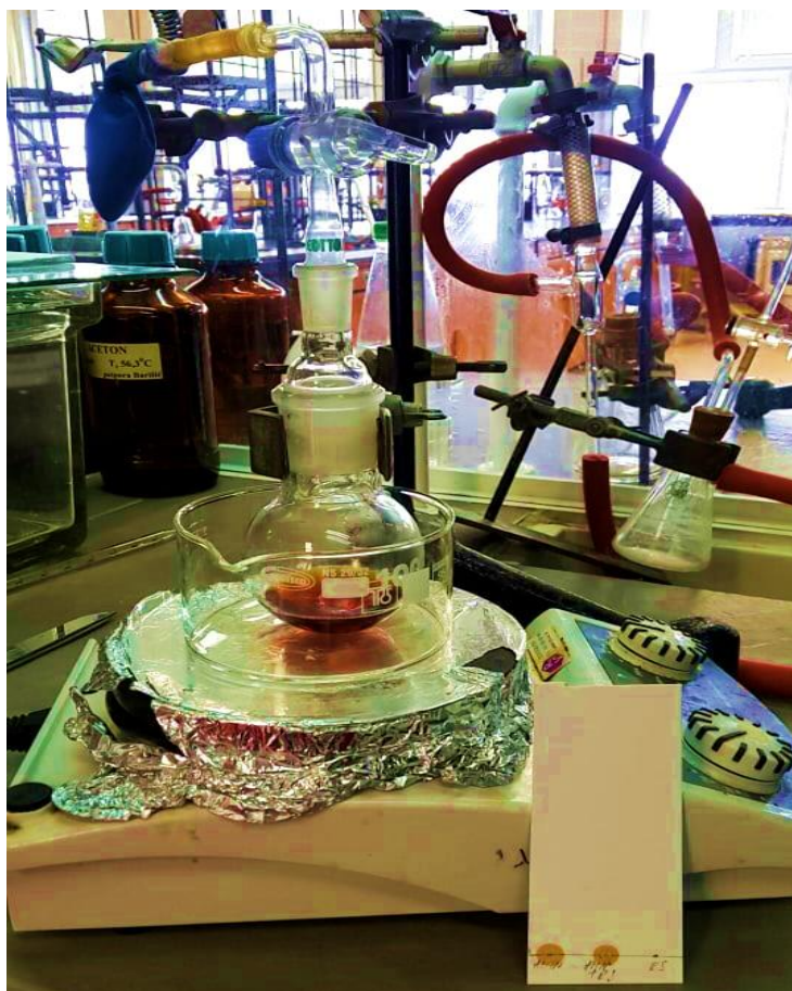
Slika 6. Aparatura za sintezu i TLC-praćenje napredovanja reakcije
