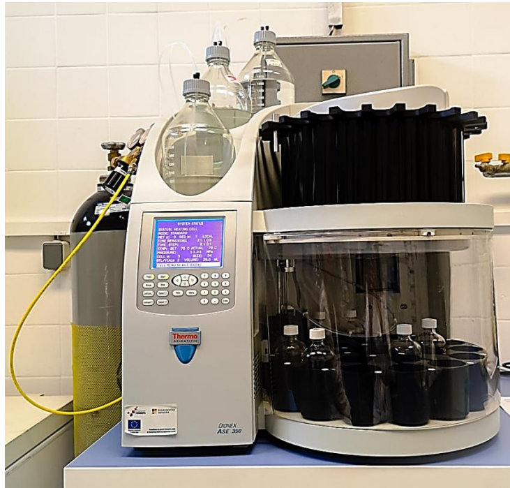
Slika 5. Uređaj za ubranu ekstrakciju otapalima pri povišenom tlaku Dionex™ ASE™ 350 (vlastita fotografija)
