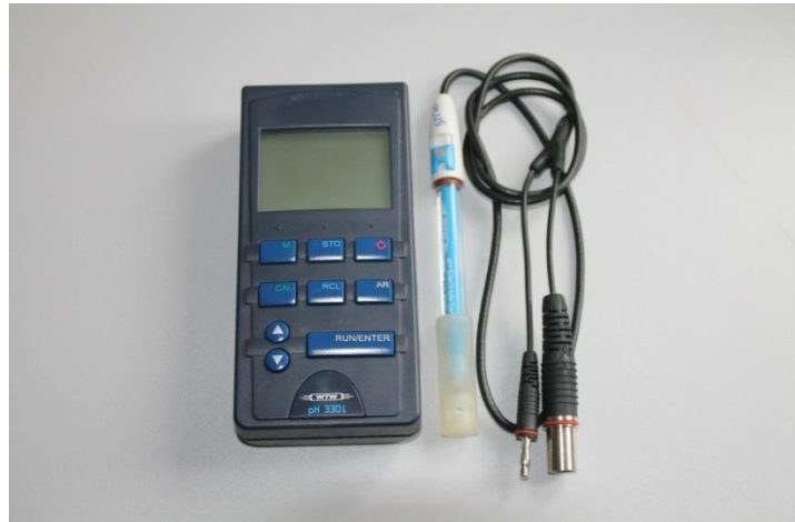
Slika 1. Digitalni pH-metar WTW Ph 330i/SET
