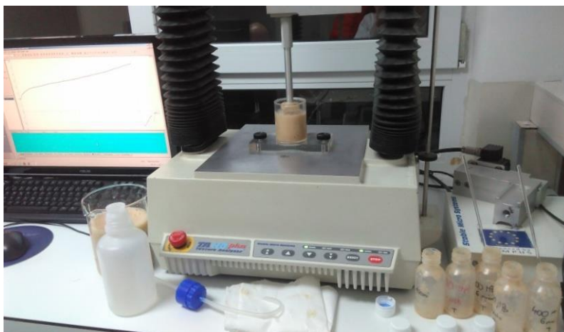
Slika 7. Uređaj za određivanje teksture Stable Micro Systems Texture Analyser TA.HDplus.
