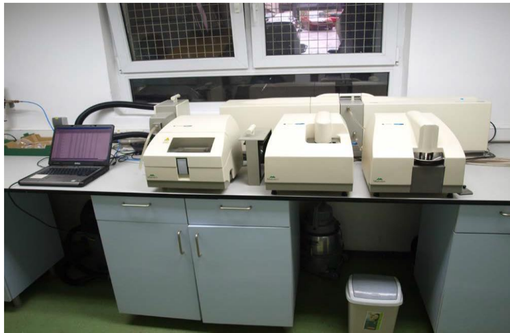
Slika 3. Uređaj za određivanje raspodjele veličine čestica Malvern Mastersizer 2000 particle size analyzer
