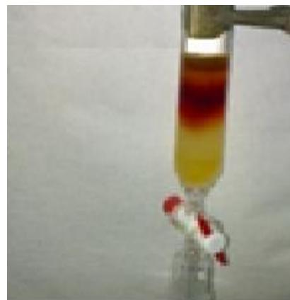
**Slika 14.** Kromatografska kolona na stupcu od silika gela pri pročišćavanju N1-ferrocenoil uracilnih derivata
