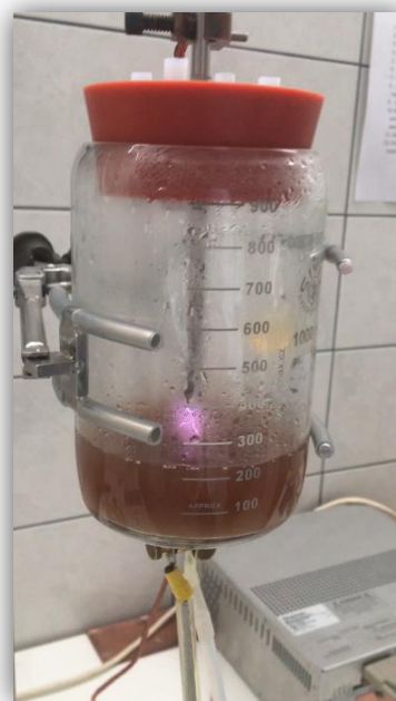
Slika 8. Tretman otpadne vode hladnom plazmom (vlastita fotografija)
