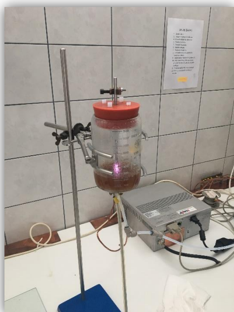
Slika 8. Tretman otpadne vode hladnom plazmom (vlastita fotografija)
