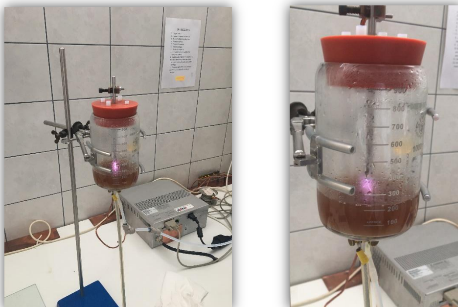
Slika 8. Tretman otpadne vode hladnom plazmom (vlastita fotografija)
