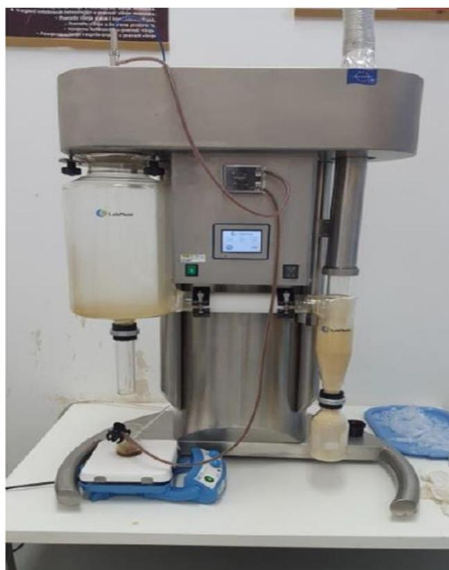
**Slika 6.** Uređaj za sušenje raspršivanjem (vlastita fotografija)
