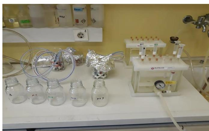
**Slika 8.** Aparatura za ekstrakciju na čvrstoj fazi (SPE)
