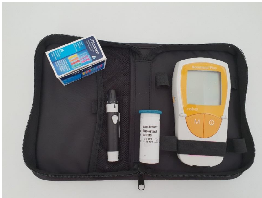
Slika 5. Uređaj za mjerenje glukoze i kolesterola iz kapilarne krvi Accutrend® Plus System (Roche Diagnostic USA).
