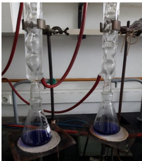
Slika 10. Zagrijavanje tikvica povezanih s povratnim hladilom (Vlastita fotografija)
