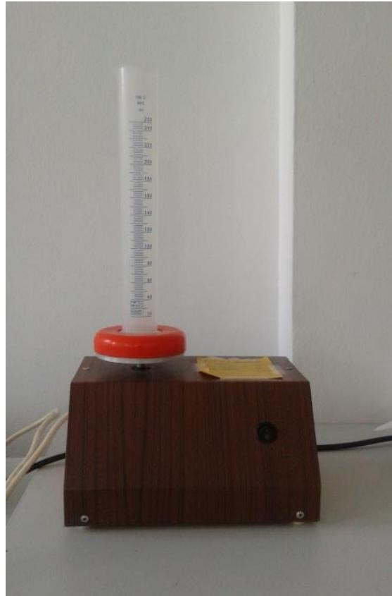
**Slika 2.** Uredaj za određivanje vibracijske nasipne gustoće (Vlastita fotografija)
