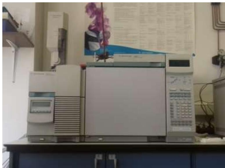
**Slika 10.** Prikaz GC-MS uređaja (vlastita fotografija)
