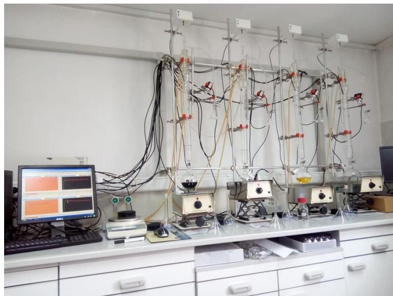
**Slika 2.** Postavljena aparatura za automatsku destilaciju (Osobna fotografija)
