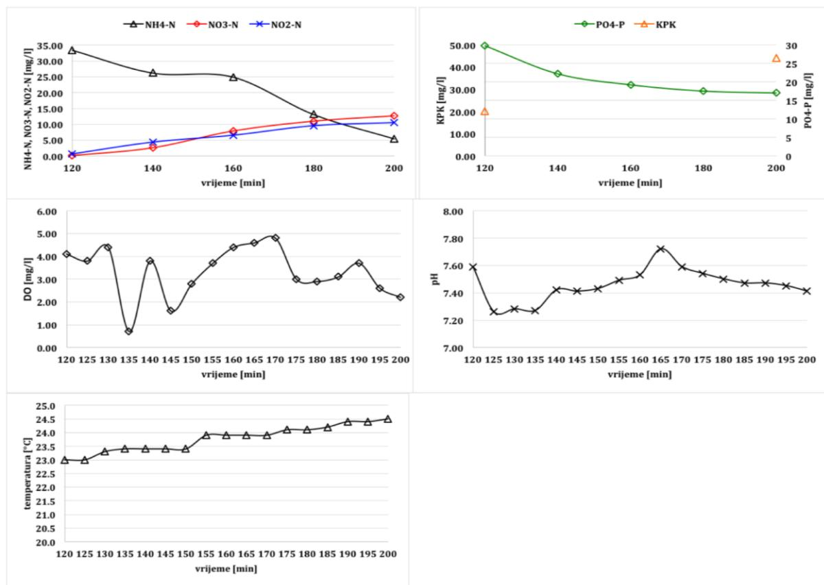
Slika 9. Promjene KPK, PO<sub>4</sub>-P, NH<sub>4</sub>-N, NO<sub>3</sub>-N, NO<sub>2</sub>-N, te pH, DO i temperature tijekom aerobnog perioda anoksično/aerobnog procesa uklanjanja P, pri C/P 1
