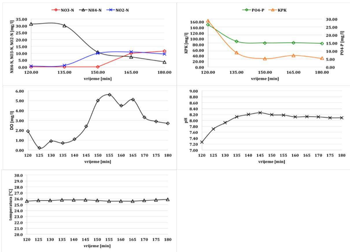
Slika 11. Promjene KPK,  $\text{PO}_4\text{-P}$ ,  $\text{NH}_4\text{-N}$ ,  $\text{NO}_3\text{-N}$ ,  $\text{NO}_2\text{-N}$ , te  $\text{pH}$ ,  $\text{DO}$  i temperature tijekom aerobnog perioda anoksično/aerobnog procesa uklanjanja P, pri C/P 5
