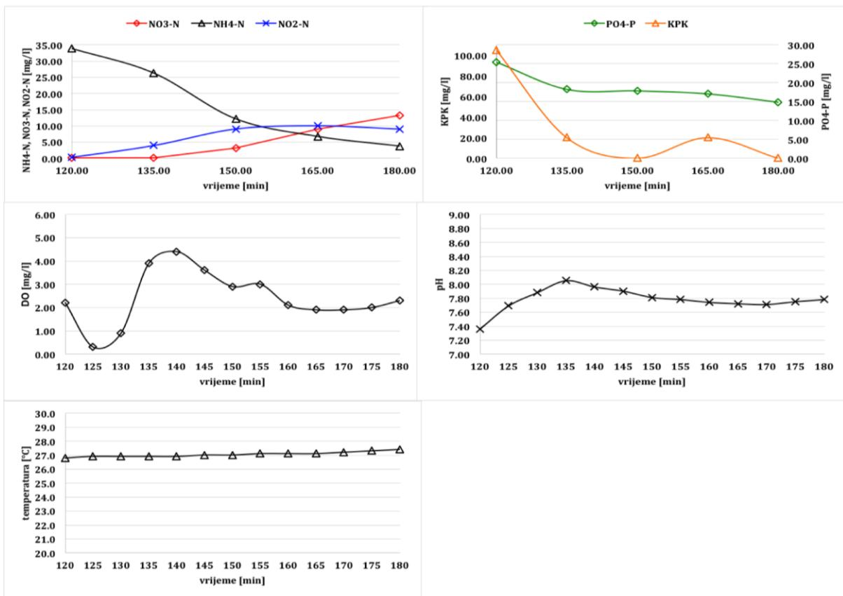
Slika 10. Promjene KPK,  $\text{PO}_4\text{-P}$ ,  $\text{NH}_4\text{-N}$ ,  $\text{NO}_3\text{-N}$ ,  $\text{NO}_2\text{-N}$ , te pH, DO i temperature tijekom aerobnog perioda anoksično/aerobnog procesa uklanjanja P, pri C/P 3
