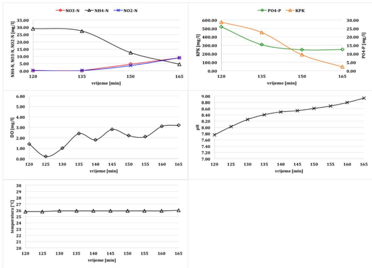
Slika 13. Promjene KPK,  $\text{PO}_4\text{-P}$ ,  $\text{NH}_4\text{-N}$ ,  $\text{NO}_3\text{-N}$ ,  $\text{NO}_2\text{-N}$ , te pH, DO i temperature tijekom aerobnog perioda anoksično/aerobnog procesa uklanjanja P, pri C/P 10
