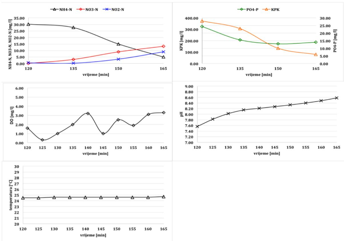
Slika 12. Promjene KPK,  $\text{PO}_4\text{-P}$ ,  $\text{NH}_4\text{-N}$ ,  $\text{NO}_3\text{-N}$ ,  $\text{NO}_2\text{-N}$ , te pH, DO i temperature tijekom aerobnog perioda anoksično/aerobnog procesa uklanjanja P, pri C/P 7
