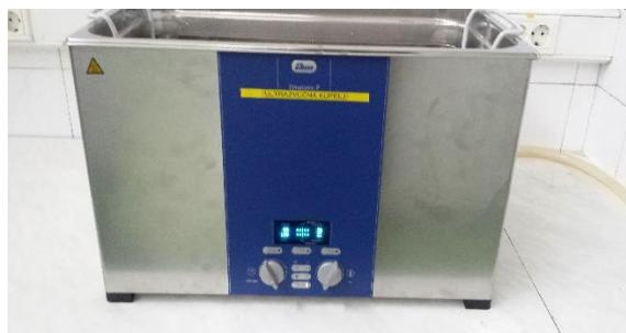
**Slika 3.** Ultrazvučna kupelj Elmasonic P 300 H (Elma, Singen, Njemačka).
