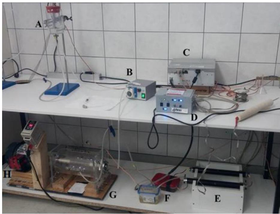
**Slika 6.** Sustav za generiranje plazme u tekućini visokonaponskim pražnjenjem: A) reaktor, B) pumpa, C) visokonaponski generator, D) kontrolna jedinica za napajanje, E) otpornici  $9,5\text{ M}\Omega$ , F) kondenzator  $0,75\text{ nF}$ , G) rotirajuća sklopka, H) elektromotor s regulatorom frekvencije (arhiva Laboratorijsa za procesno-prehrambeno inženjerstvo).
