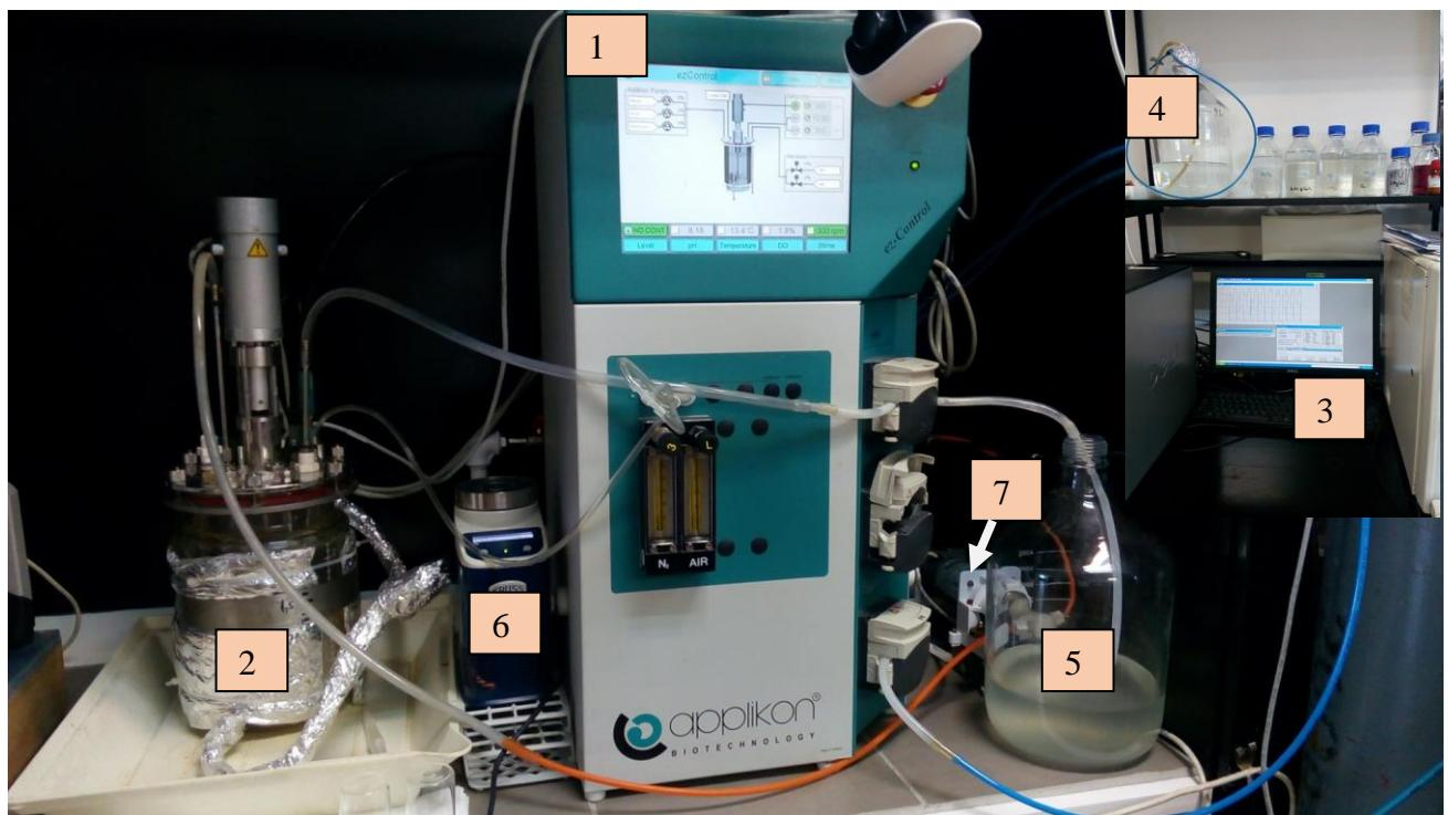
**Slika 4.** SBR: 1.) kontrolno-upravljačka jedinica, 2.) reaktor, 3.) računalo za vođenje procesa, 4.) spremnik influenta 5.) spremnik efluenta, 6.) protočni termostat 7.) pumpa za izuzimanje viška mulja (vlastita fotografija)
