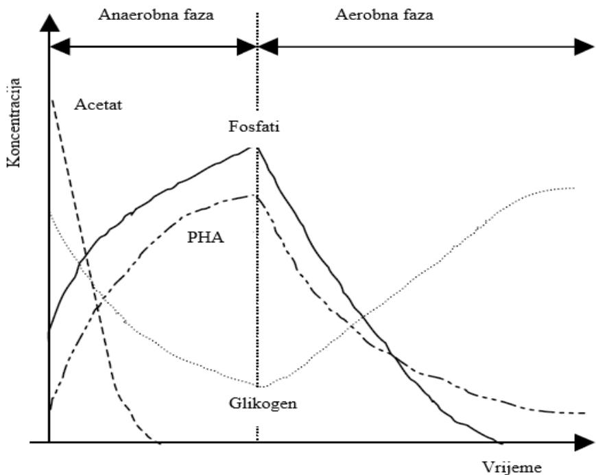
**Slika 2.** Koncentracijski profil komponenata u EBPR-u pod anaerobnim i aerobnim uvjetima (Beatens, 2000).
