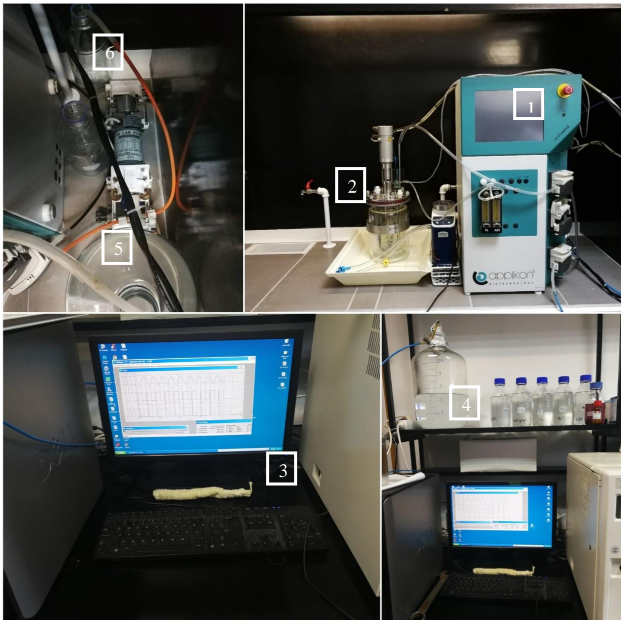
Slika 6. Laboratorijski SBR s kontrolno-upravljačkom jedinicom
