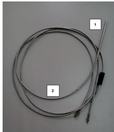
Slika 4. Sonda (1), Optički kablovi (2)
