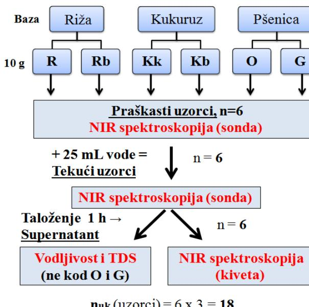
Slika 2. Shematski prikaz procesa pripreme i mjerjenja uzorka osnovnih sirovina
