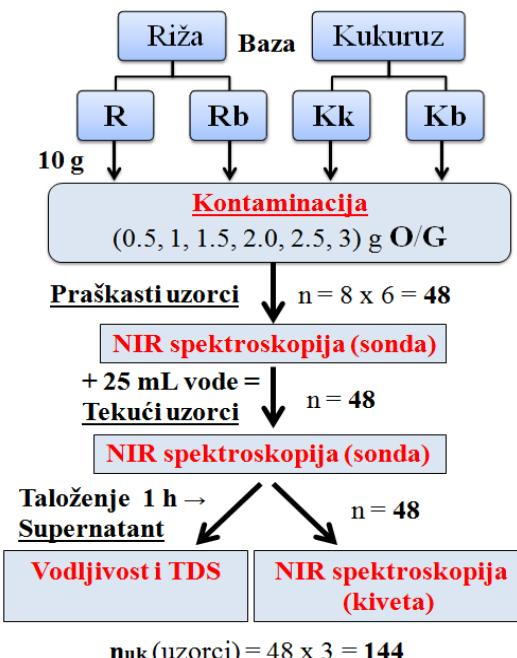
Slika 1. Shematski prikaz procesa pripreme i mjerena kontaminiranih uzoraka
