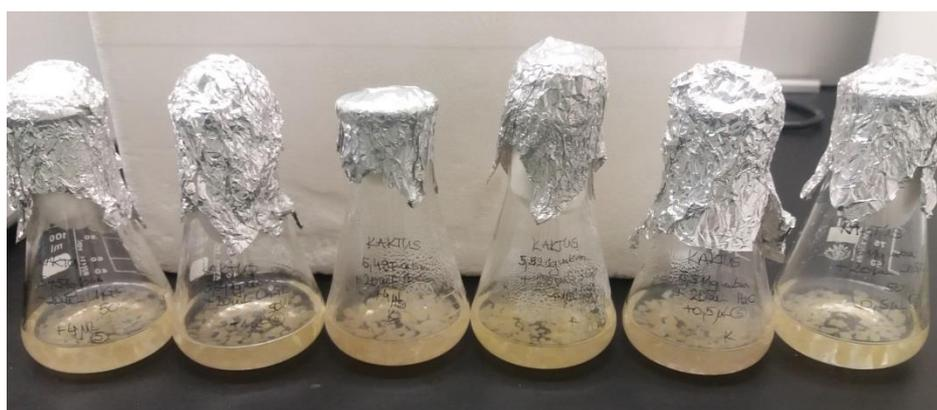
Slika 8. Tikvice sa reakcijskom smjesom nakon provedene reakcije biotransformacije DMPA u trajanju od 2 dana, s kalusnom kulturom kaktusa kao biokatalizatorom (vlastita fotografija).
