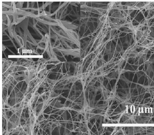
**Slika 5.** SEM snimka bakterijske celuloze koja prikazuje koherentnu 3D mrežu formiranu pomoću celuloznih vlakana povezanih fizičkim zglobovima (Ul-Islam i sur., 2012)
