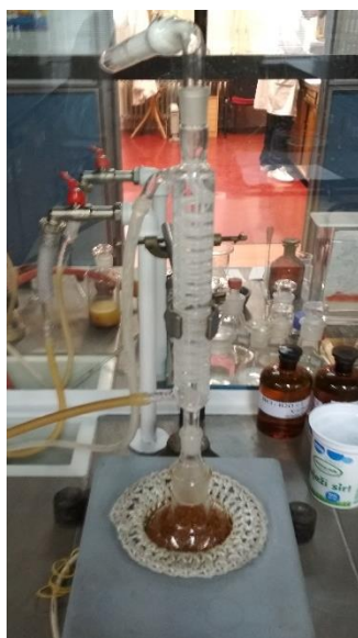
Slika 8. Korištena aparatura za refluksiranje
