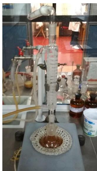
Slika 8. Korištena aparatura za refluksiranje
