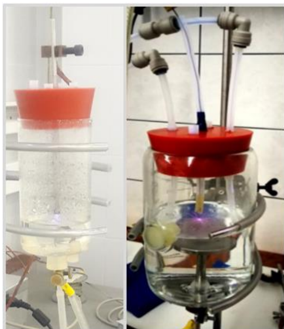
Slika 10. Izgled reaktora korištenih prilikom plazma tretmana destilirane vode u volumenima od 100 i 200 mL (lijevo) te 500 mL (desno)
