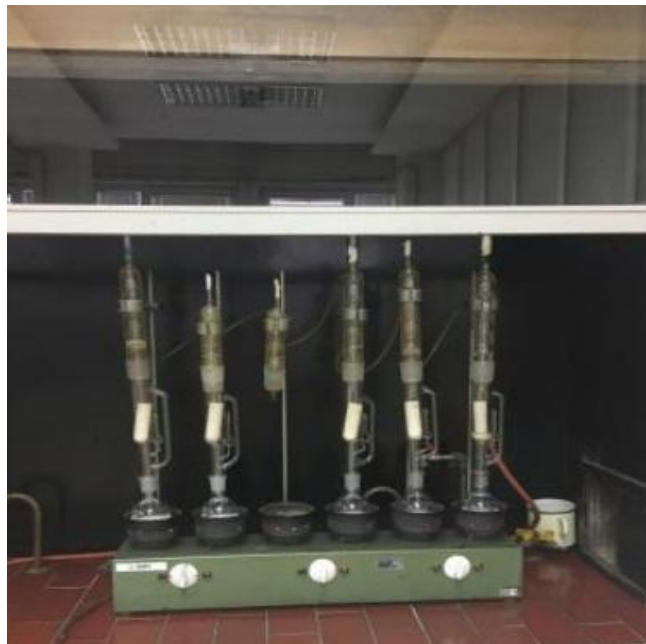
Slika 3. Aparatura po Soxheltu (vlastiti izvor)
