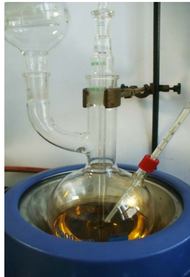
Slika 12. Tikvica i parna cijev
