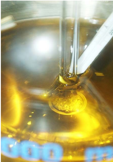
Slika 11. Dno parne cijevi
