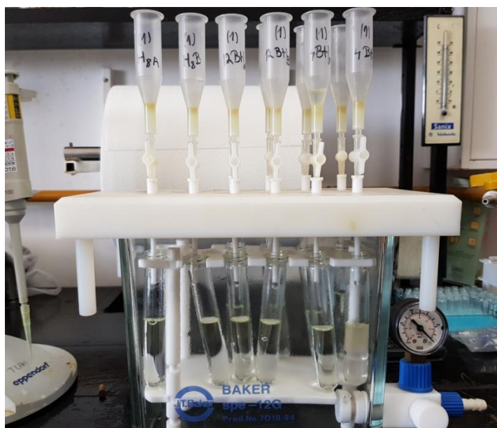
Slika 6. Priprema kolona ionskih izmjenjivača
