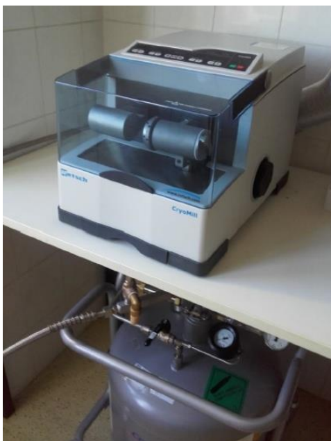
Slika 5. Vibracioni kriomlin + spremnik za tekući dušik
