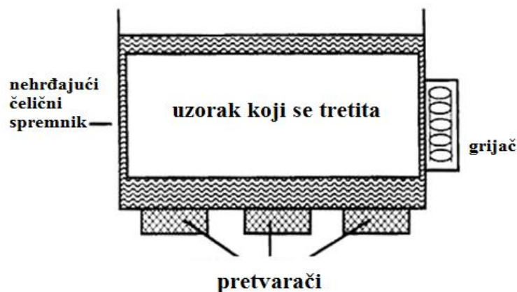
Slika 5. Ultrazvučna kupelj (Gogate i sur., 2006)
