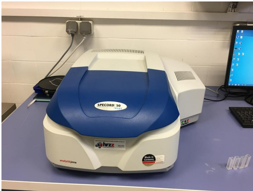
Slika 3. Spektrofotometar (Specord 50 Plus), AnalytikJena, Jena, Njemačka
