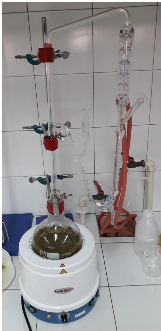
Slika 5. Aparatura za Calvenger vodenu destilaciju (vlastita fotografija)
