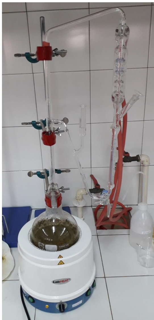
Slika 5. Aparatura za Calvenger vodenu destilaciju (vlastita fotografija)
