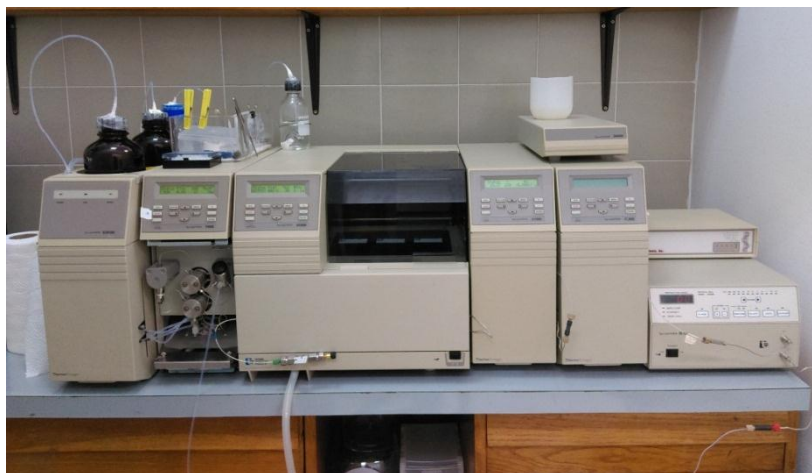
Slika 7. Sustav za tekućinsku kromatografiju visoke učinkovitosti (HPLC).
