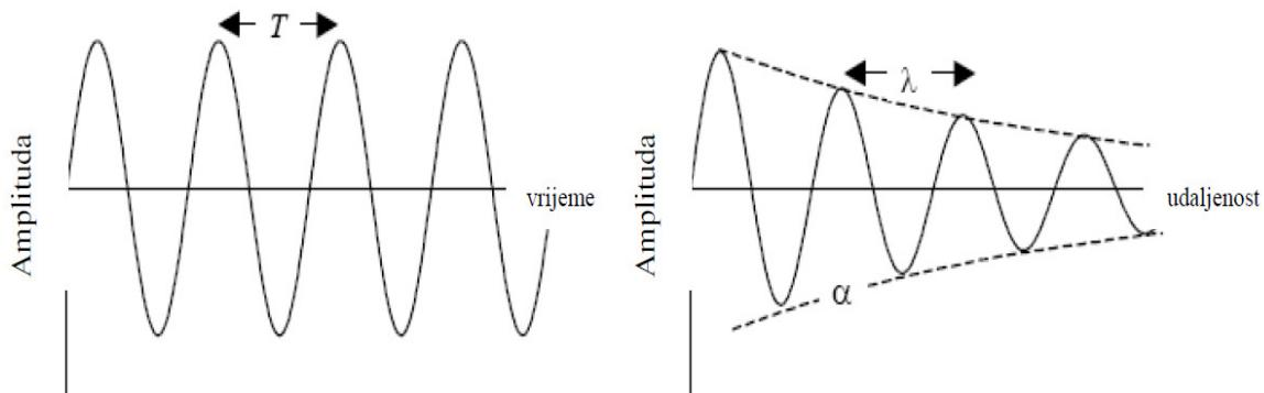
Slika 2. Promjene amplitude ultrazvuka kod određenih položaja u materijalu (lijevo), te kod određenog vremena (desno).  $T$  je udaljenost između susjednih maksimuma vala,  $\lambda$  je valna duljina i  $\alpha$  je koeficijent atenuacije (McClements, 1995).
