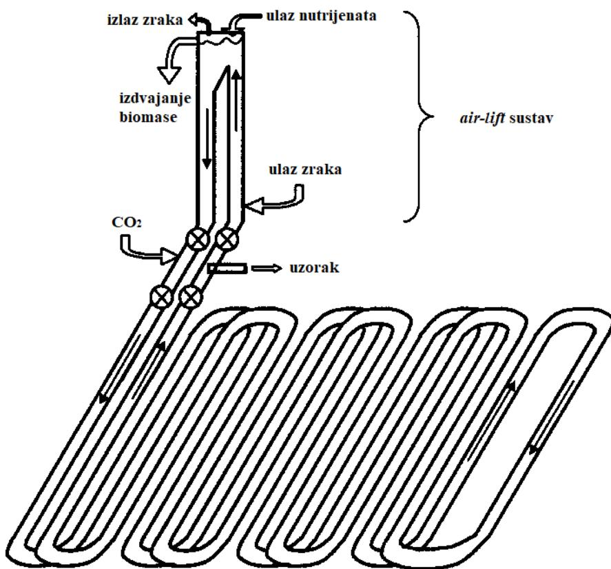
**Slika 3.** Cijevni fotobioreaktor (Brennan i Owende, 2010).
