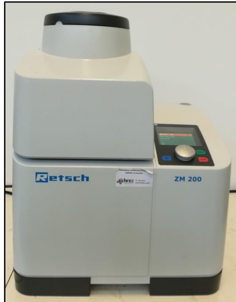
Slika 4. Ultra-centrifugalni mlin (vlastita fotografija).
