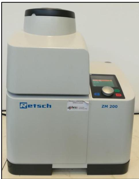
Slika 4. Ultra-centrifugalni mlin (vlastita fotografija).
