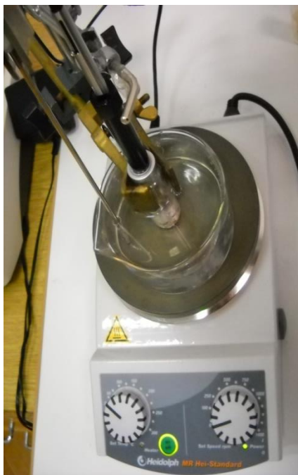
Slika 8. Aparatura za mikroekstrakciju vršnih para na krutoj fazi (HS-SPME) (Marijanović, 2014)
