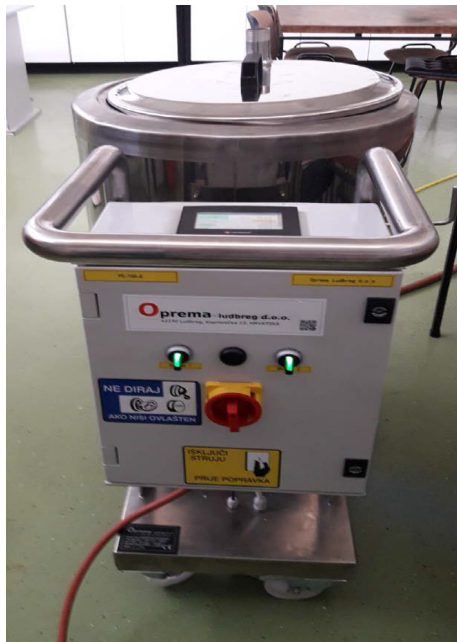
Slika 8. Šaržni pasterizator PS 100
