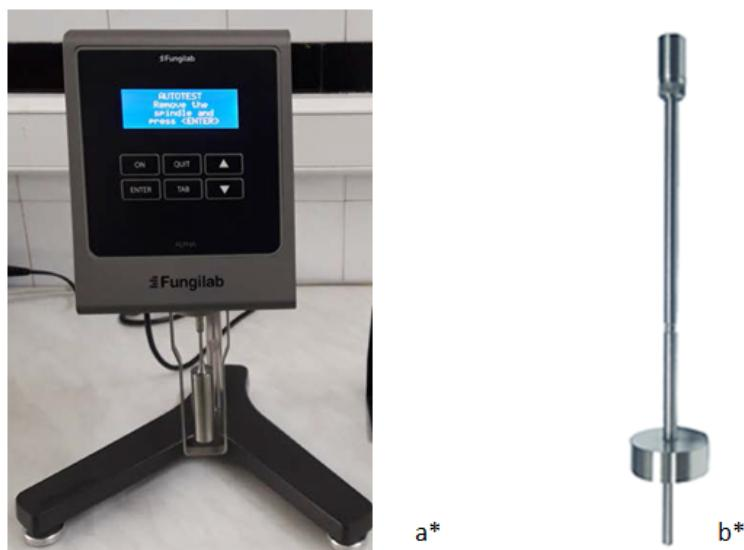
Slika 13. Viskozimetar Fungilab ALPHA (a\*) i L2 mjerno vratilo (b\*)
