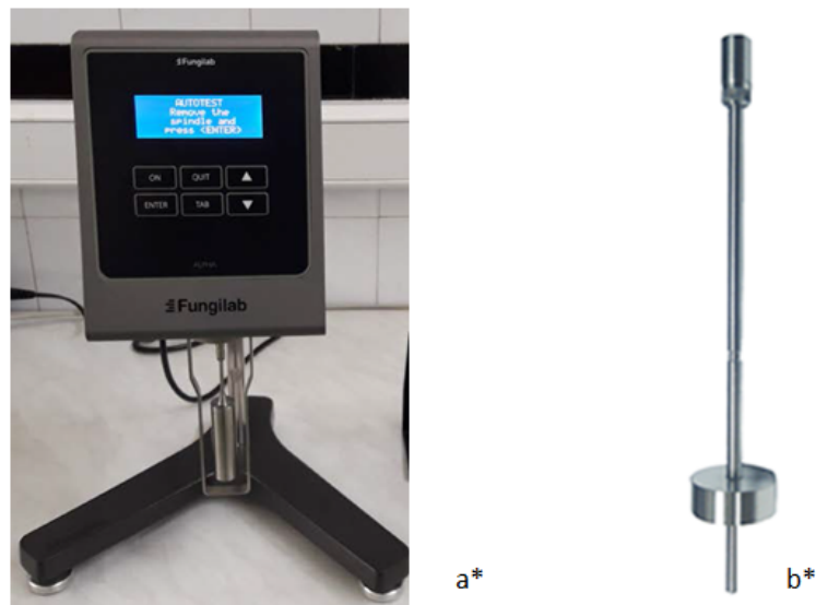
Slika 13. Viskoizimetar Fungilab ALPHA (a*) i L2 mjerno vratilo (b*)
