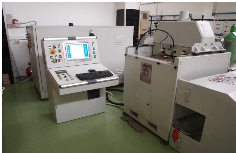
Slika 7. Uređaj za obradu visokim hidrostatskim tlakom "Stansed Fluid Power" (Velika Britanija)
