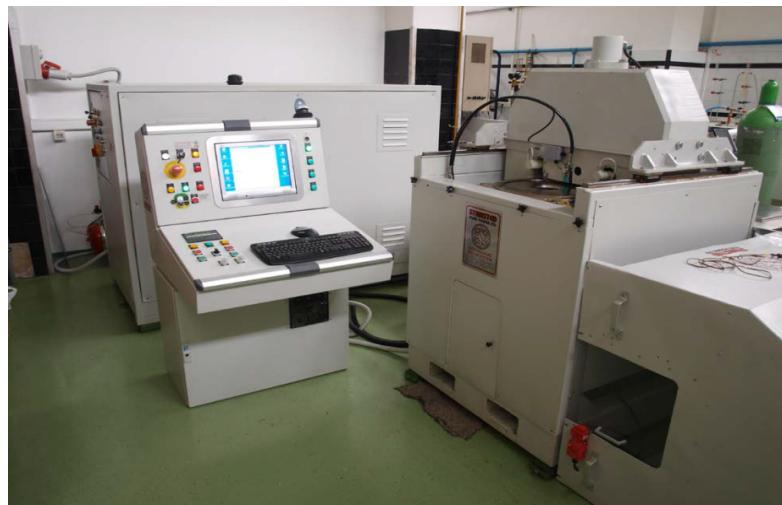
Slika 7. Uređaj za obradu visokim hidrostatskim tlakom "Stansted Fluid Power" (Velika Britanija)
