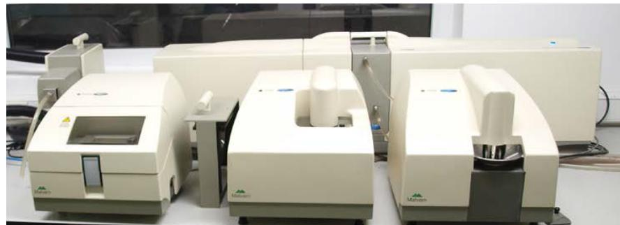
Slika 12. Mastersizer 2000 s vanjskom jedinicom Hydro 2000S
