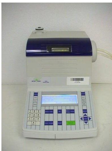
Slika 11. Mjerač gustoće Mettler Toledo DE40, Švicarska
