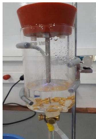
**Slika 10.** Hibridni plazma reaktor (*vlastita fotografija*)
