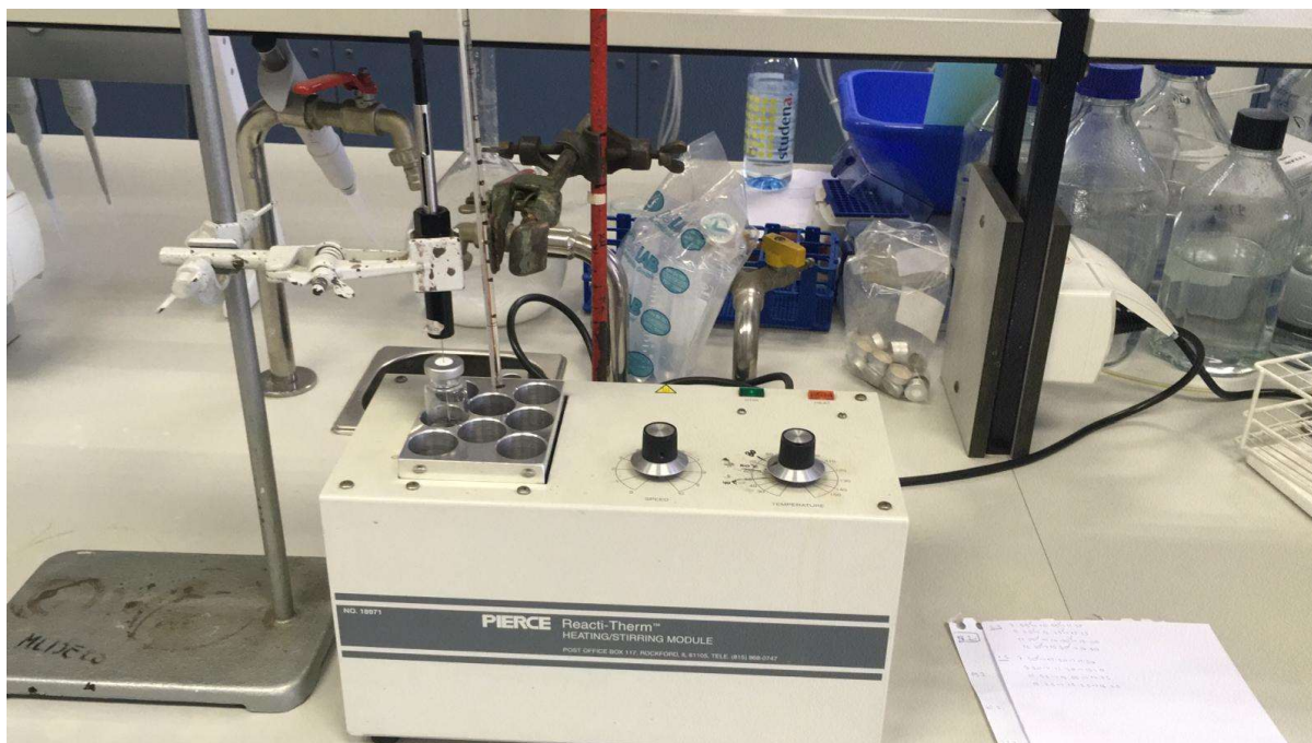
Slika 8. HS-SPME ekstrakcija (vlastita fotografija)
