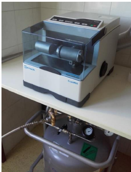
Slika 4. Vibracijski kriomlin sa spremnikom tekućeg dušika (Vlastita fotografija)
