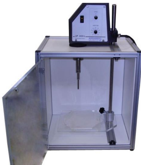
Slika 6. Ultrazvučni uređaj UP400S (Mofardin, 2013)
