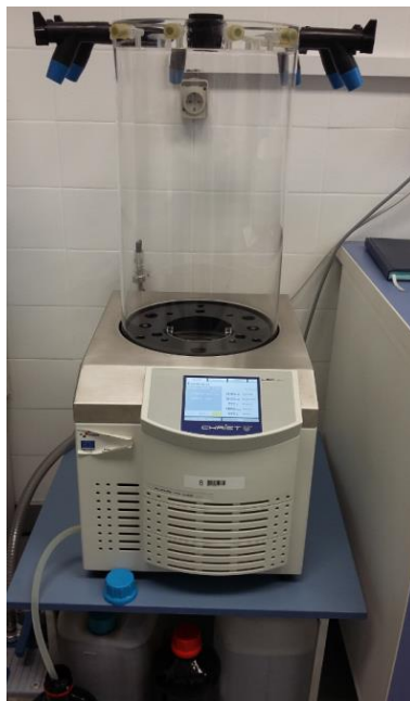
Slika 7. Liofilizator Alpha 1-4 LSC (Vlastita fotografija)
