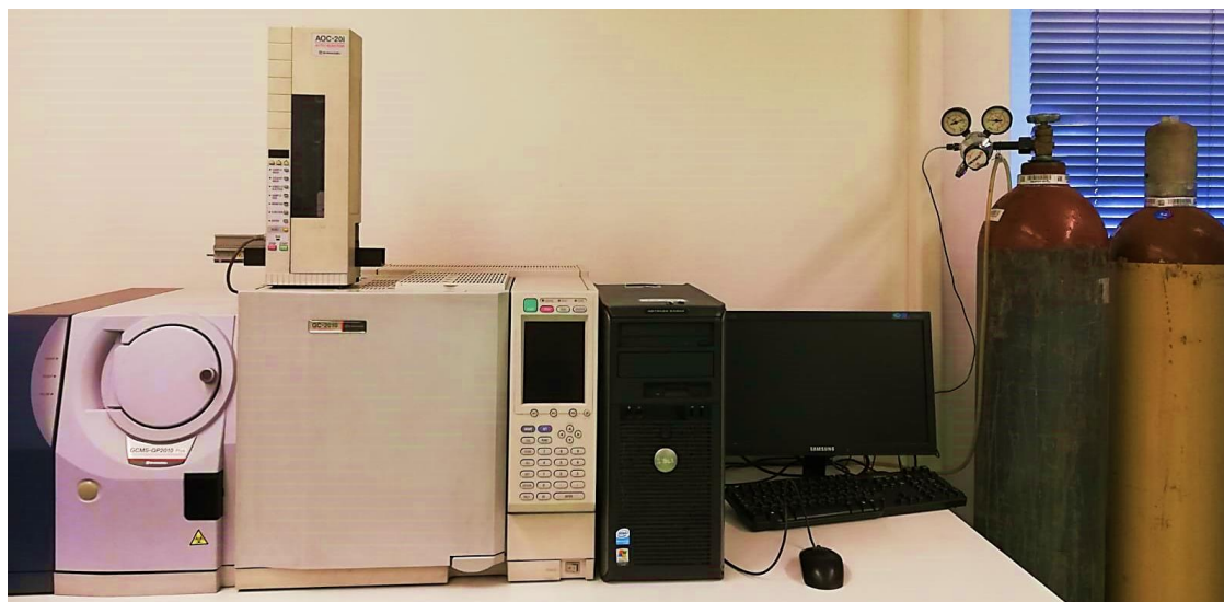
Slika 6. Plinski kromatograf s masenim spektrofotometrom (GC-MS), Shimadzu QP2010PLUS, Japan.
