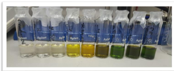
Slika 13. Otopljeni pigmenti u bezvodnom etanolu (Vlastita fotografija)
