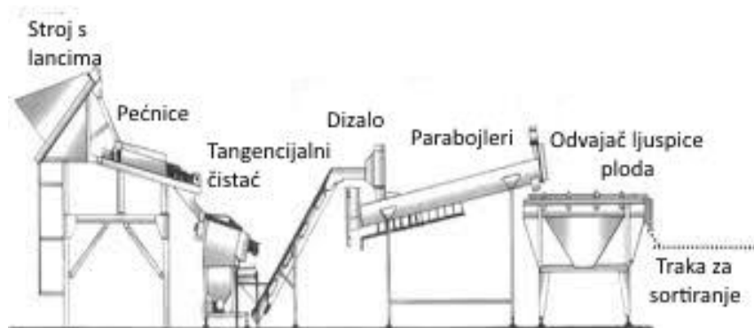
Slika 11. Prikaz linije za ljuštenje kestena tehnikom brulage (Guyer i sur., 2005).
