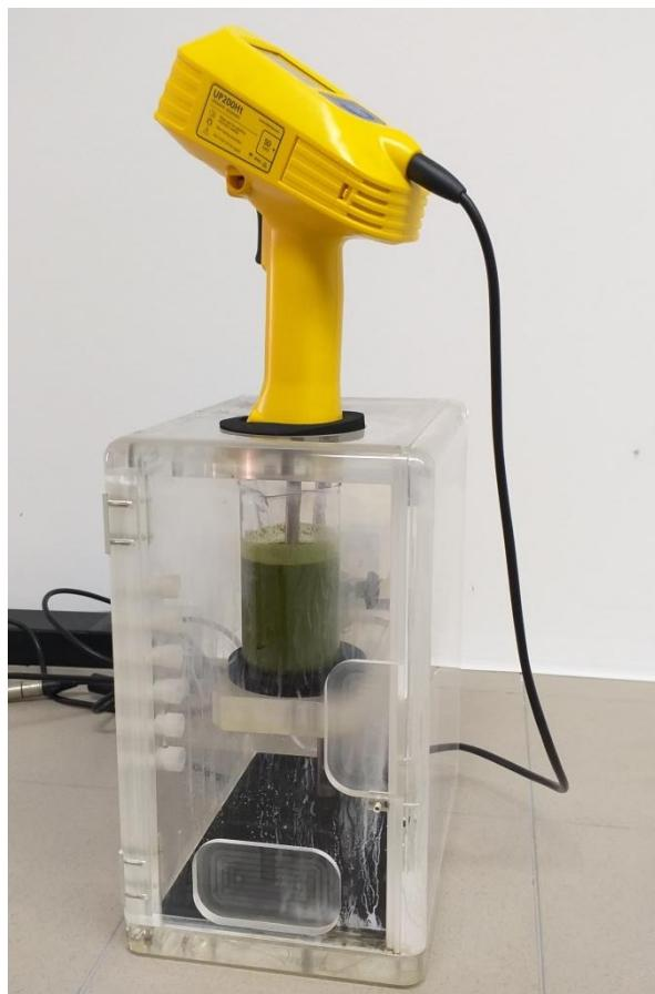
**Slika 10.** Ekstrakcija potpomognuta ultrazvukom (vlastita fotografija)
