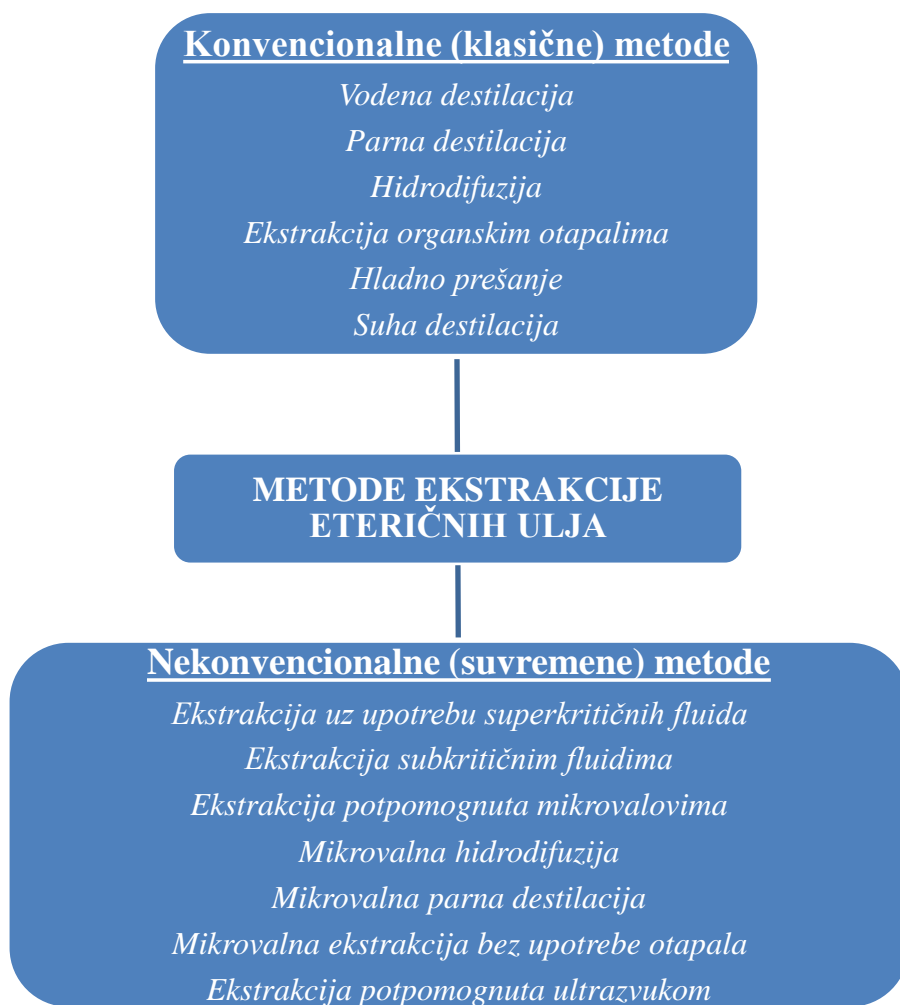
Slika 3. Metode ekstrakcije eteričnih ulja (Dima i Dima, 2015)
