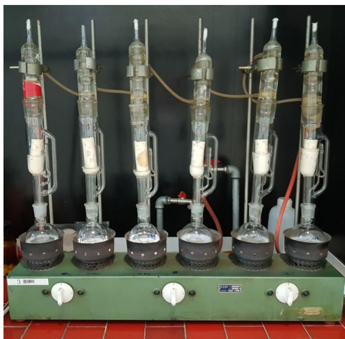
Slika 18. Aparatura po Soxhletu (vlastita fotografija)
