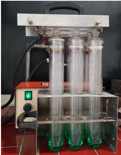
Slika 14. Blok za spaljivanje (vlastita fotografija)
