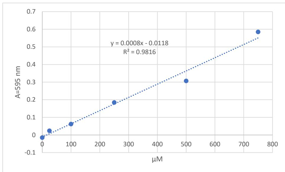
**Slika 12.** Baždarni pravac za određivanje antioksidacijskog kapaciteta
