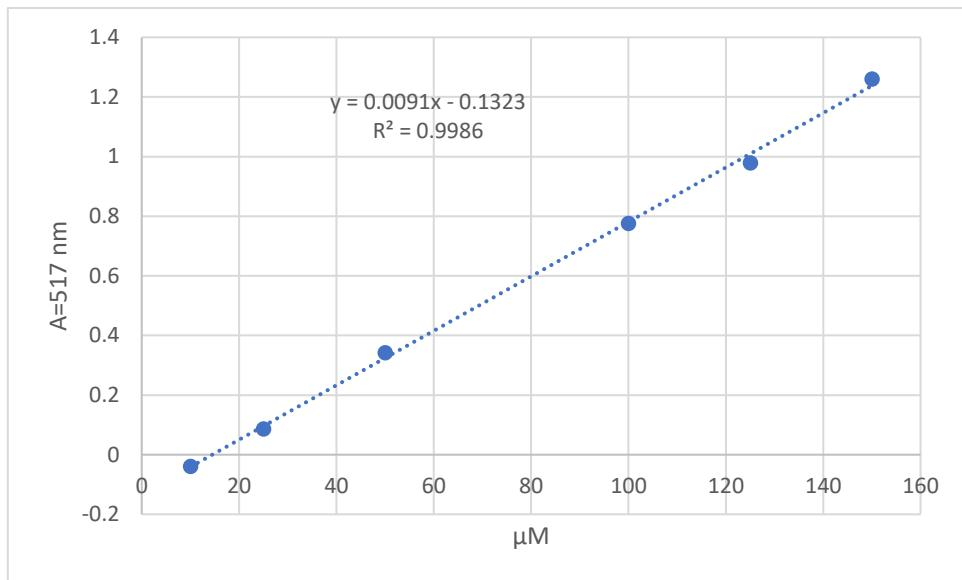
**Slika 11.** Baždarni pravac za određivanje antioksidacijske aktivnosti
