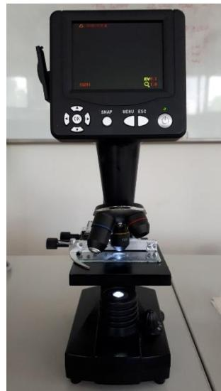
Slika 8. Mikroskop sa digitalnom kamerom za snimanje promjera kapljica u emulziji (vlastita slika)
