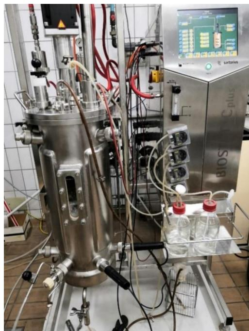
**Slika 4.** Bioreaktor s miješalom Biostat Cplus (Sartorius BBI Systems GmbH, Njemačka)
