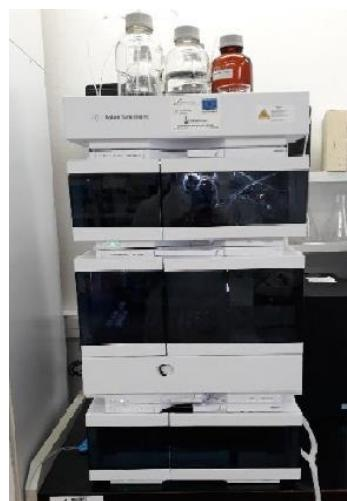
**Slika 5.** UPLC uređaj 1290 Infinity II (Agilent Technologies, Santa Clara, SAD)
