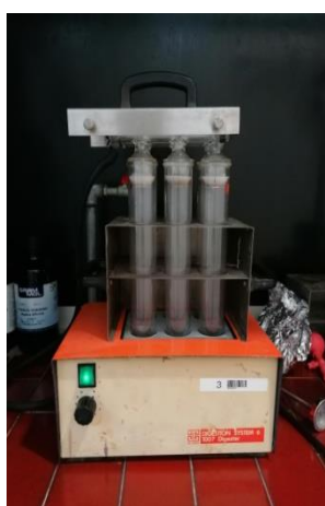
Slika 2. Blok za spaljivanje (vlastita fotografija)
