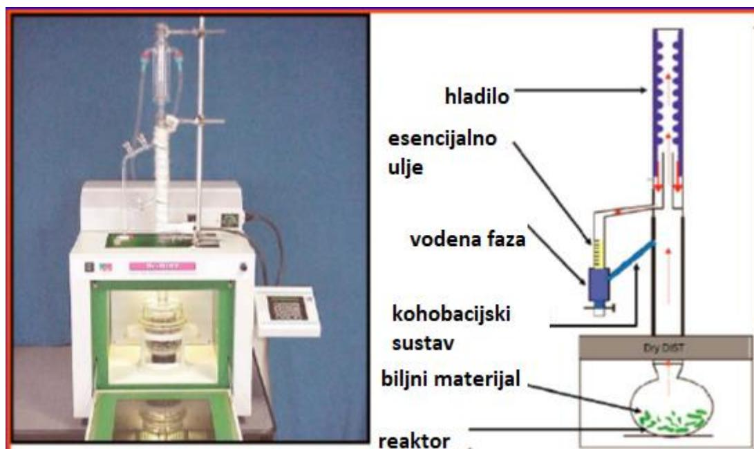
Slika 14. Prikaz mikrovalnog reaktora (Ferhat i sur., 2007)
