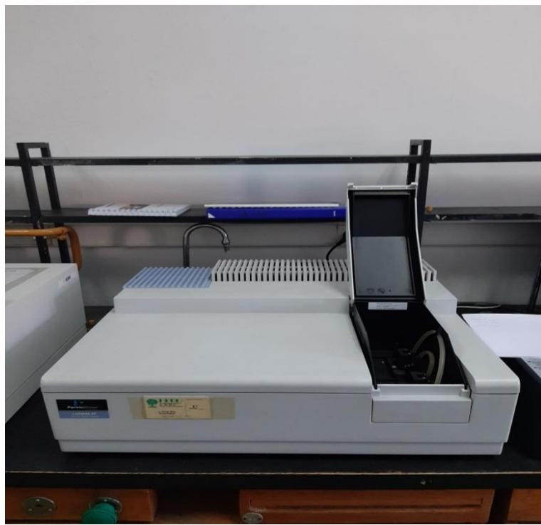
Slika 20. UV/VIS spektrofotometar Perkin Elmer Lambda 25
