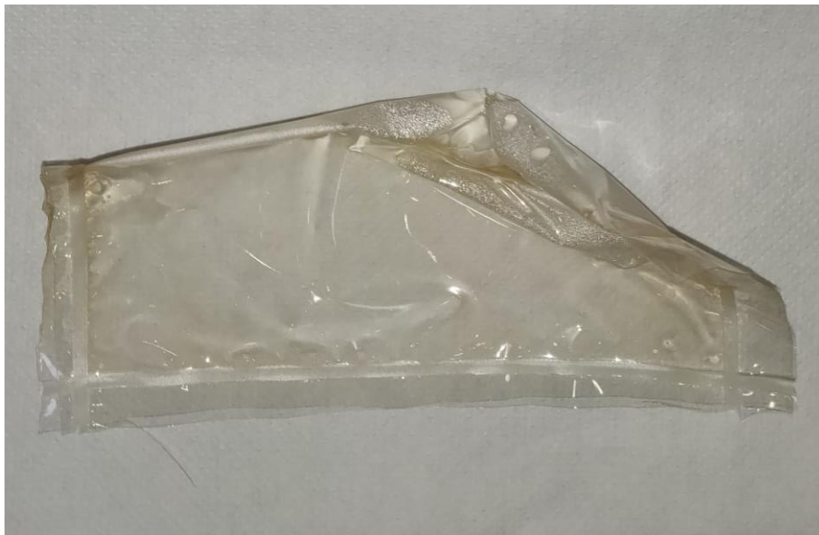
Slika 4. Primjer oštećene PP/Ac/PVDC ambalaže nakon tretmana udaljenost= 9,75 cm i vrijeme=60 sec (vlastita slika)
