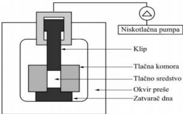
**Slika 1.** Diskontinuirani uređaj za obradu visokim tlakom (Lovrić, 2003)
