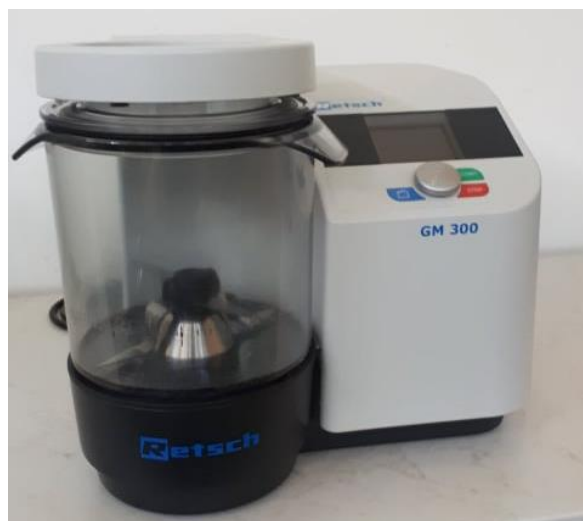
Slika 3. Uređaj za usitnjavanje RETSCH GM 300
