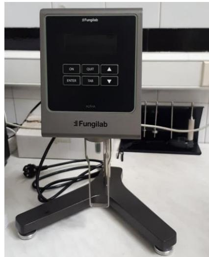
**Slika 7.** Digitalni viskozimetar Fungilab ALPHA
