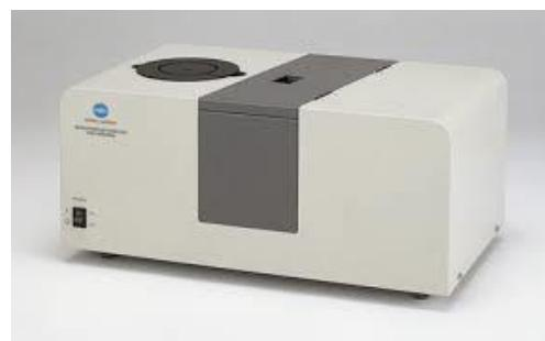
**Slika 5.** Kolorimetar KONICA-MINOLTA CM-3500-d
