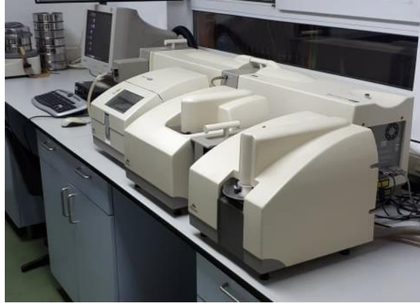
Slika 8. Mastersizer 2000 s vanjskom jedinicom Hydro 2000S
