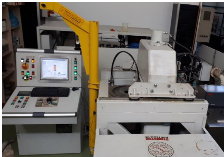
Slika 4. Uređaj za obradu namirnica visokim hidrostatskim tlakom Stansted Fluid Power
