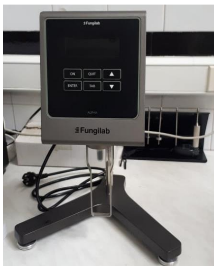
Slika 7. Digitalni viskozimetar Fungilab ALPHA
