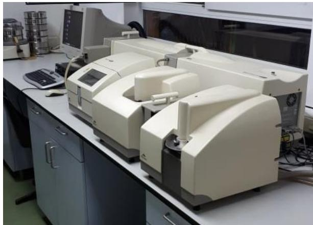
**Slika 8.** Mastersizer 2000 s vanjskom jedinicom Hydro 2000S
