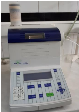
Slika 6. Mjerač gustoće Mettler Toledo DE 40
