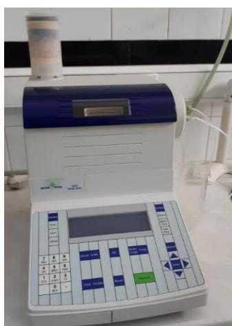
**Slika 6.** Mjerač gustoće Mettler Toledo DE 40
