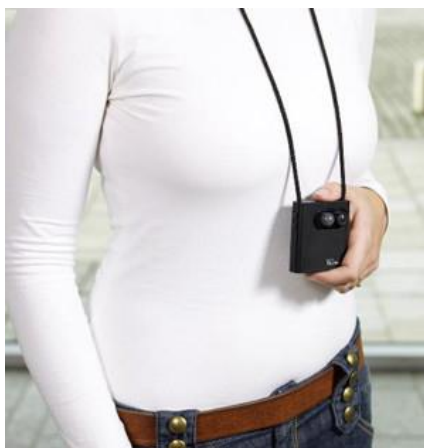
Slika 7. Prikaz nosive kamere „SenseCam“ (Kelly i sur., 2011)
